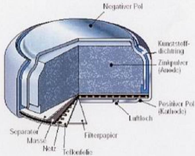
Dieses System wird überwiegend als Knopfzelle bis zu den kleinsten Abmessungen gefertigt. Es ähnelt im Aufbau den Alkali-Mangan-Zellen. Batterien dieser Art benötigen sehr teure Rohstoffe. Ihr Einsatz ist daher auf Anwendungen beschränkt geblieben, die auf kleinsten Raum eine Batterie mit hohem Energieinhalt und hoher Belastung benötigen.
