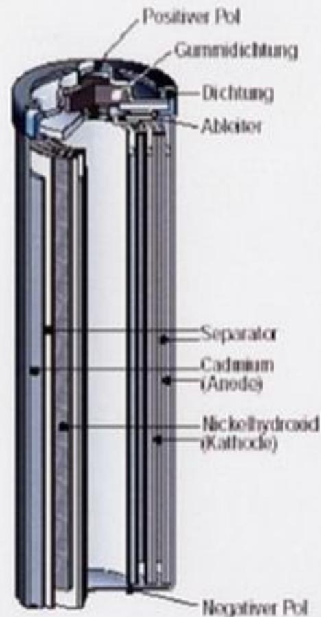
Die Vorteile dieses Batteriesystems, auch gegenüber neueren Akku-Systemen, sind hohe Belastbarkeit, Schnellladefähigkeit und Kältefestigkeit bis minus 15°C. Ein Nachteil gegenüber alkalischen und Lithium-Primärsystemen ist der relativ geringe Energieinhalt. Außerdem kann es zum „Memory-Effekt“ kommen.
