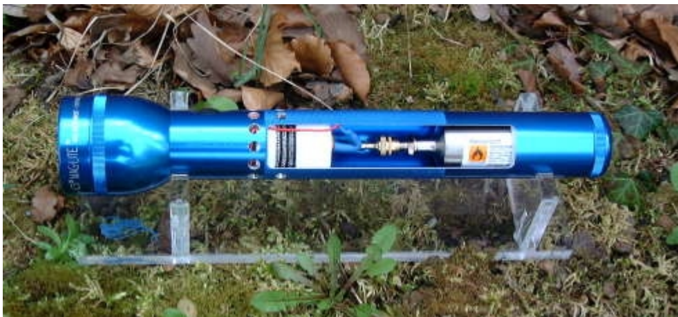
Abbildung 5-4: Autonomes Brennstoffzellensystem als Ersatz für konventionelle Batterien /ZSW 03b/
