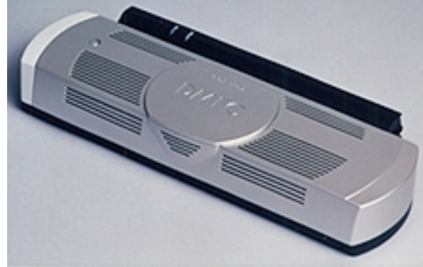
Abbildung 5-10: Notebook-Dockingstation von Toshiba mit DMFC
